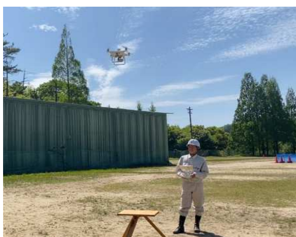
写真測量のためのUAVによる撮影
