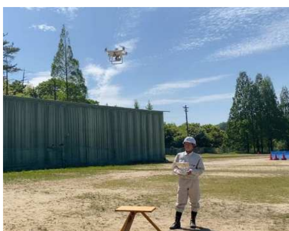
写真測量のためのドローンによる撮影
