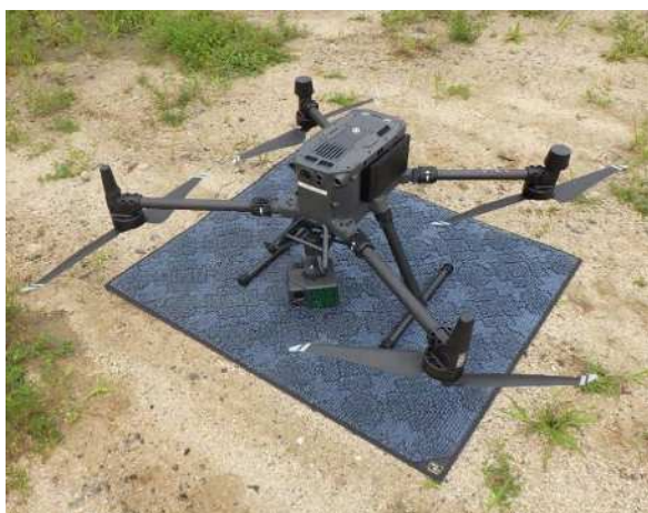
レーザースキャナ搭載UAVによる測量
