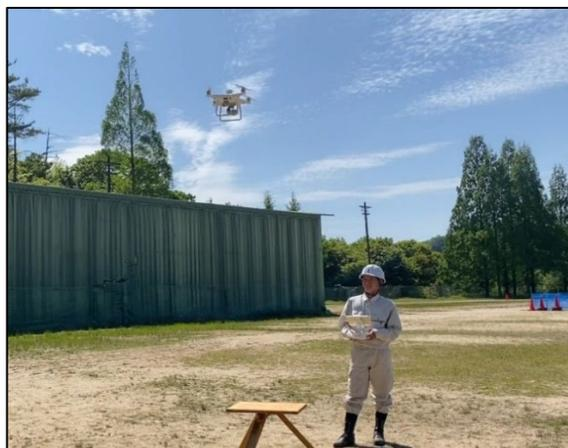
写真測量のためのドローンによる撮影
